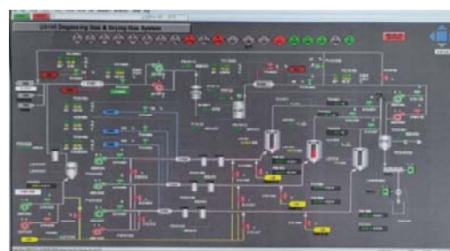
รูปที่ 6 จอแสดงการรวบรวมสาร VOCs จากกระบวนการผลิตและดึงเก็บกัก เพื่อนำไปทำลายที่หอเผา
